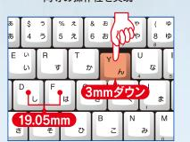
Caps Lock と Ctrlキーの 切換が底面にあるスイッチ により可能
